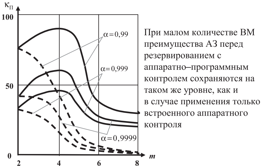
Рис. III.3.24. Графики (сплошные линии) отношения коэффициента простоя ИС с резервированием кратности 1/m и с высоким уровнем встроенного аппаратного контроля ( 0,99 \leq \alpha \leq 1 ) к коэффициенту простоя ИС с дисциплиной Д6 при \rho=0,001 , \gamma=0,8 ; графики (штриховые линии), построенные при тех же условиях, но при применении аппаратно – программного контроля ВМ
