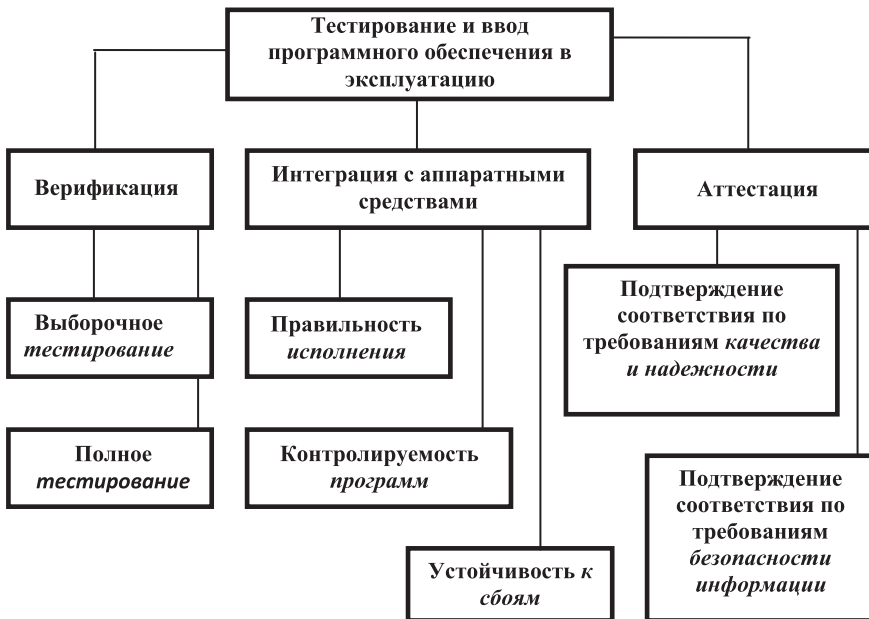
Рис. III.4.12. Порядок ввода в эксплуатацию надежного программного обеспечения
