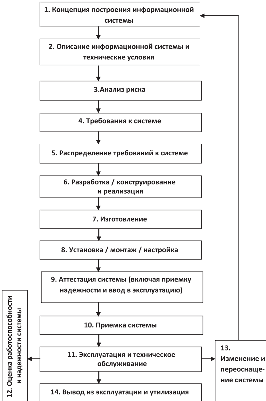
Рис. III.1.2. Жизненный цикл надежности информационной системы
