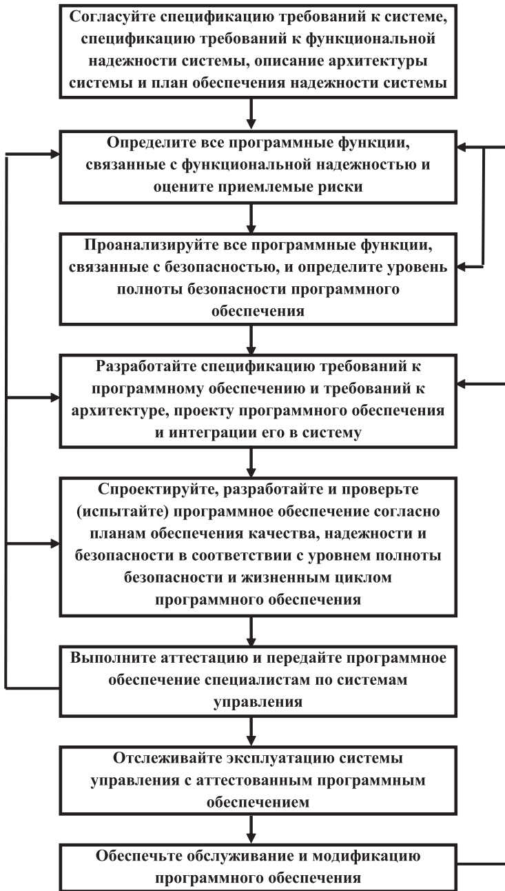
Рис. III.4.2. Маршрутная карта функциональной надежности программного обеспечения
