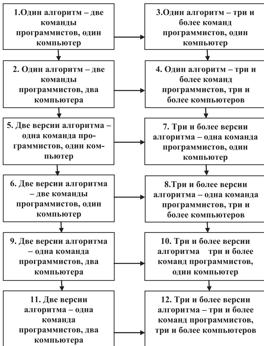
Рис. III.4.7. Способы реализации многоверсионного программирования
