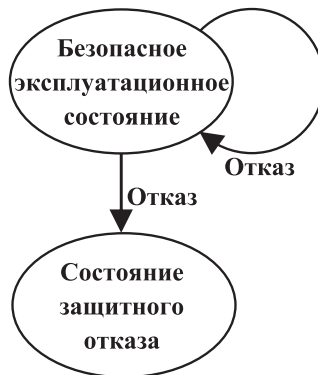
Рис. III.5.2. Строгое представление принципа отказобезопасности
